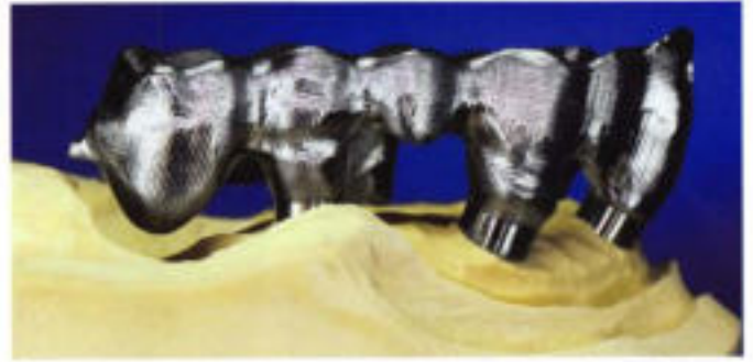
☉7 Der Sheffield-Test (nur eine Implantatschraube wird angezogen) ...
